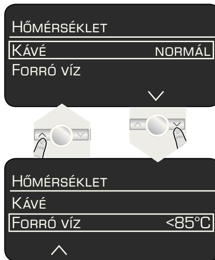
A **°C** gomb **3** újból megnyomása elmeneti a hőmérsékletet és visszatér az ital kiválasztáshoz.
